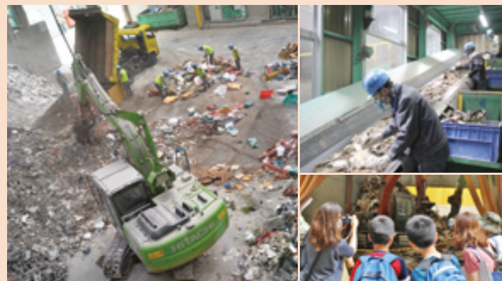
先進装置と人の手による徹底したライン選別を組み合わせることでリサイクル率98%を達成。電動式油圧ショベルの導入でCO2排出量を大幅に削減するなど、環境にも配慮している
